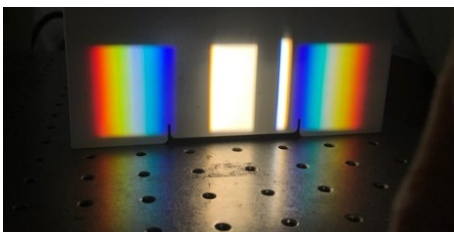
Diffrazione di luce bianca da un reticolo di trasmissione.
