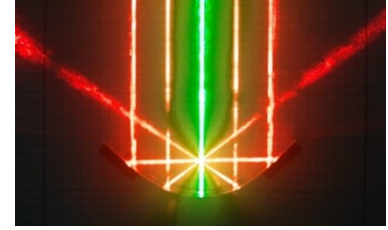
Concentrazione della luce laser tramite specchio parabolico.
