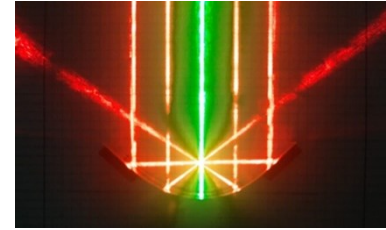
Concentrazione della luce laser tramite specchio parabolico.
