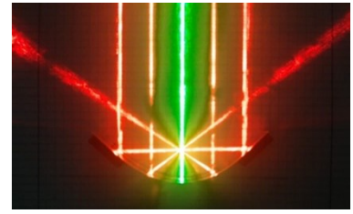
Concentrazione della luce laser tramite specchio parabolico.
