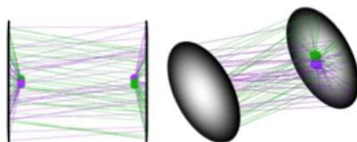
A) I principi dell'ottica a incidenza normale, vengono visualizzati con l'utilizzo di due parabole, una lampada a media potenza, e uno schermo per la focalizzazione dell'immagine.
