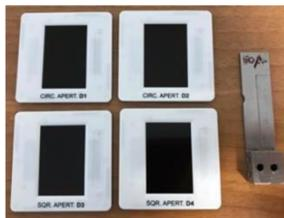
Si utilizzeranno fenditure e aperture di forma diversa per osservare le figure di diffrazione generate da un laser di bassa potenza, e calcolare la lunghezza d'onda della luce dalla spaziatura delle frange. Le esperienze comprendono anche esperimenti con prismi e lenti per formare immagini e costruire un prototipo di cannocchiale.
