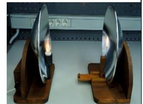
B) Quando la lampada viene alimentata alla massima potenza, si innesca la combustione di un fiammifero. La leggenda racconta che, in modo simile durante l'assedio di Siracusa, Archimede incendiò navi romane con i famosi "specchi ustori".
