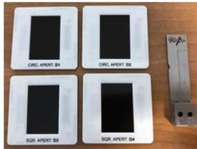
Si utilizzeranno fenditure e aperture di forma per osservare le figure di diffrazione generate da un laser di bassa potenza, e calcolare la lunghezza d'onda della luce dalla spaziatura delle frange. Le esperienze comprendono anche esperimenti con prismi e lenti per la formazione di immagini.
