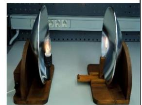
B) Quando la lampada viene alimentata alla massima potenza, si innesca la combustione di un fiammifero. La leggenda racconta che, in
